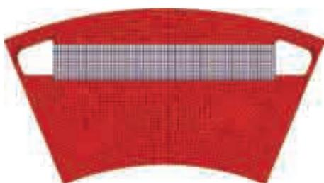
图5 电机转子有限元模型网格划分
