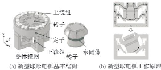
图4 新型球形电机基本结构和工作原理
