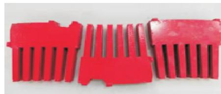
图 22 防腐表面试样
