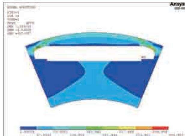
图 11 优化后电机转子矽钢片的等效应力分布
