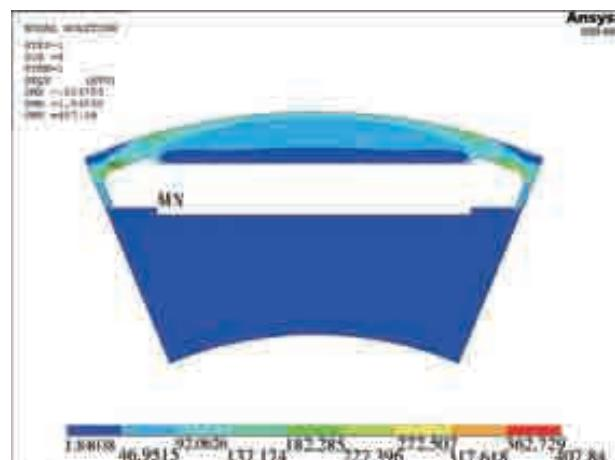
图7 电机转子矽钢片的等效应力分布
