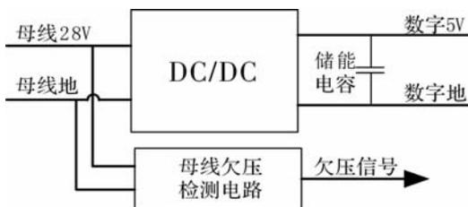
图 4 母线欠压监测电路图
