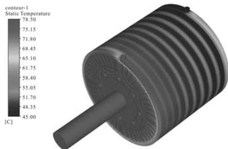
图 15 电机整体表面温度分布云图
