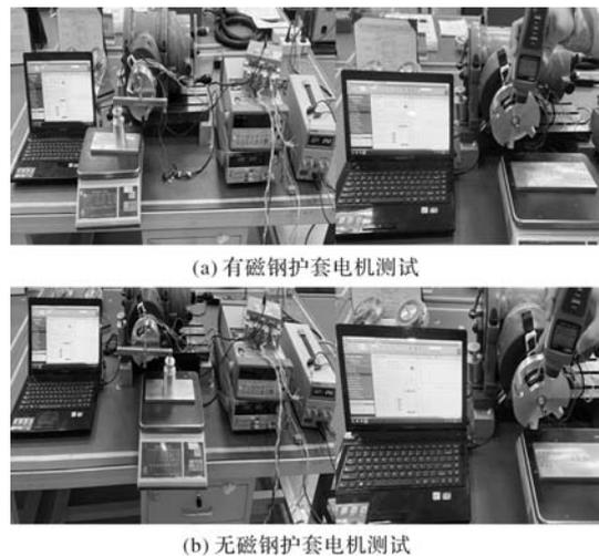
图 8 工程样机测试平台
