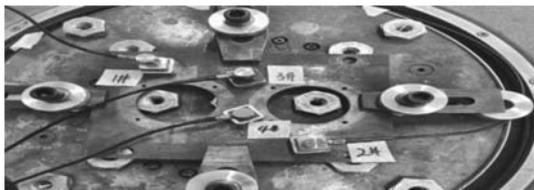
图 7 铁材料板状夹具(控制传感器安装在就近试品)
