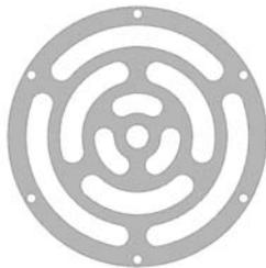
图 8 弹簧片的结构
