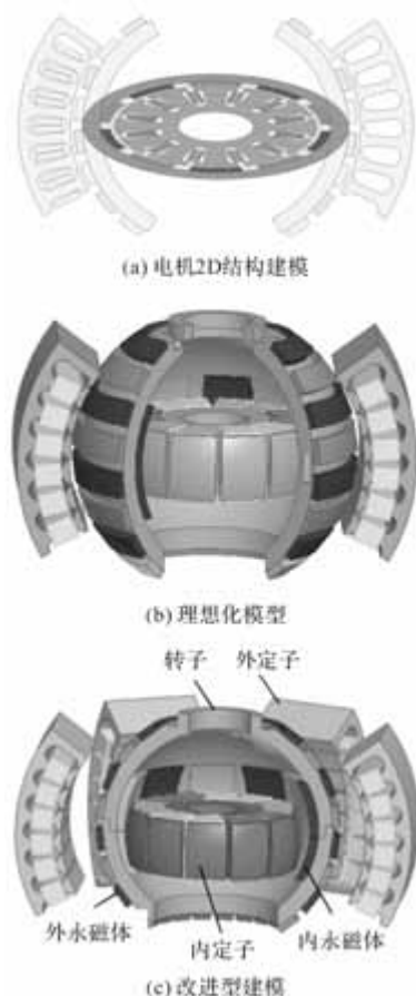
图 1 电机理想 3D 电磁结构的建模过程
