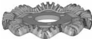
图8 定子基座受约束状态下的 B_{09} 振型示意图
