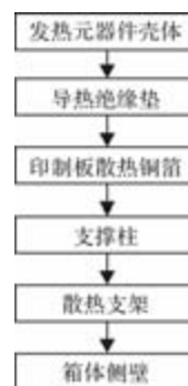
图6 双路DC/DC电源模块传导路径框图
