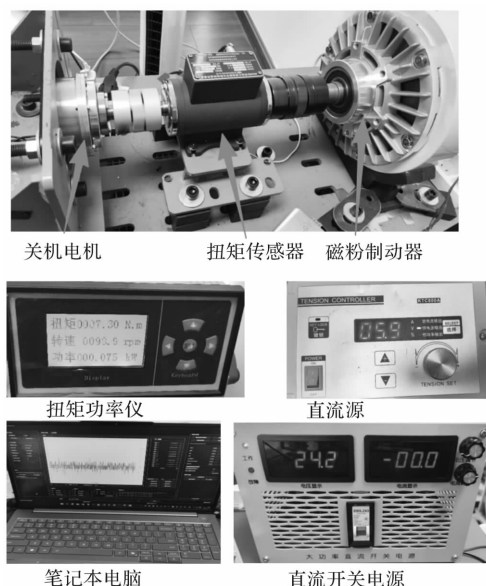
图 10 关节电机测试平台
